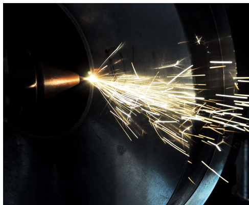
Fabricación aditiva por Laser cladding. AIDO
