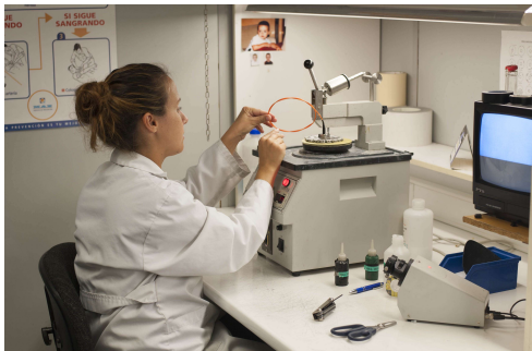
Técnica de Fibercom realizando el pulido de conectores de fibra óptica. Fibercom
