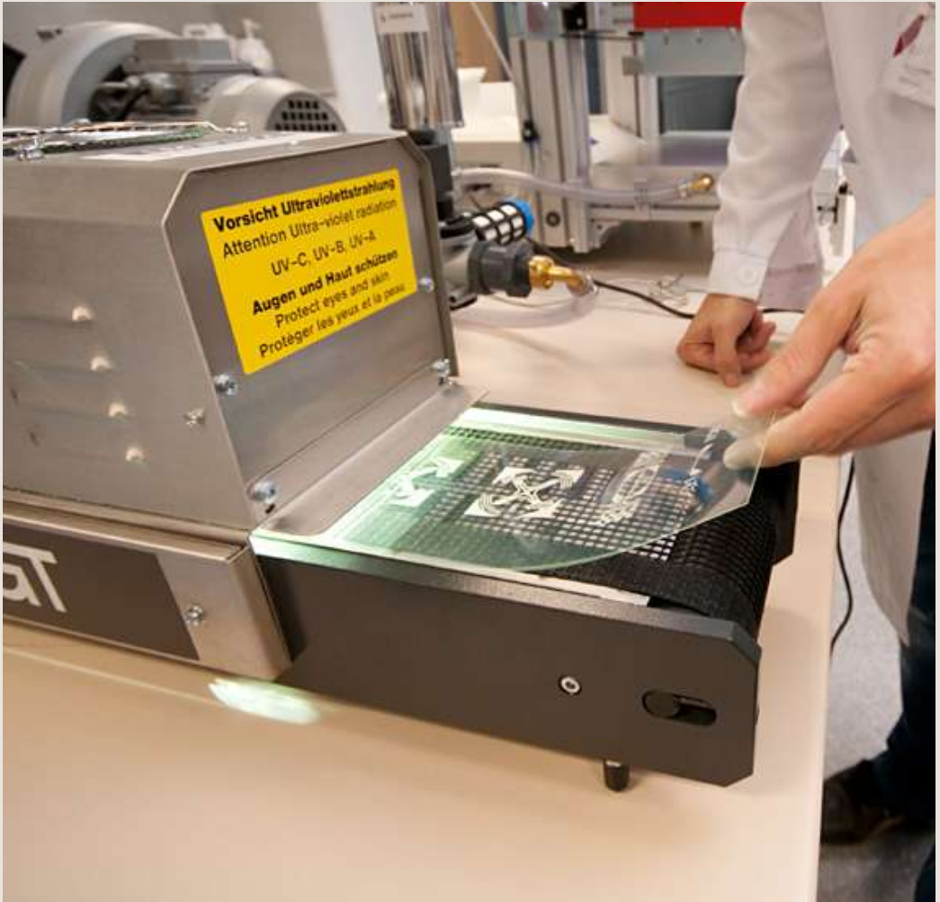
Impresión funcional sobre sustrato flexible. AIDO
