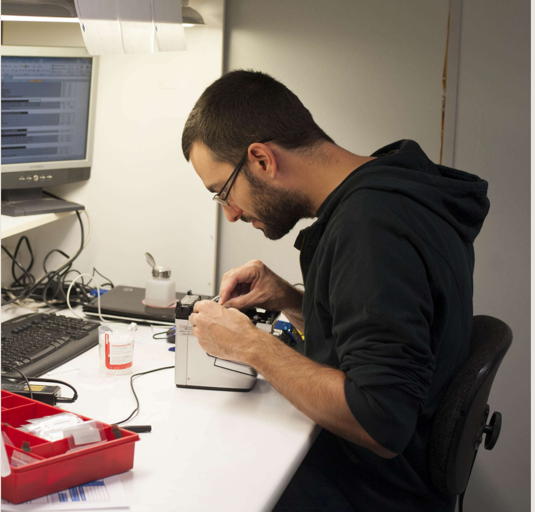
Técnico de Fibercom reparando un equipo de fusión de fibra óptica. Fibercom
